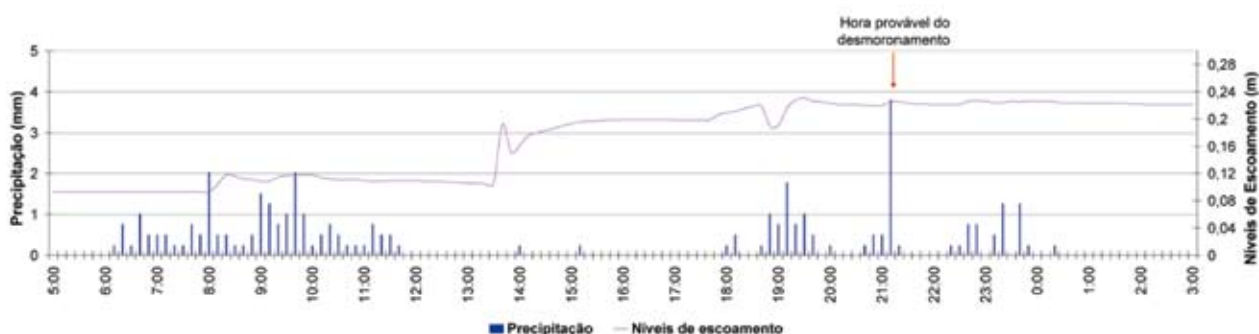
Fig.10 - Precipitação e níveis de escoamento da bacia hidrográfica no dia 18 de Agosto de 2006 (episódio de precipitação do tipo 3).
