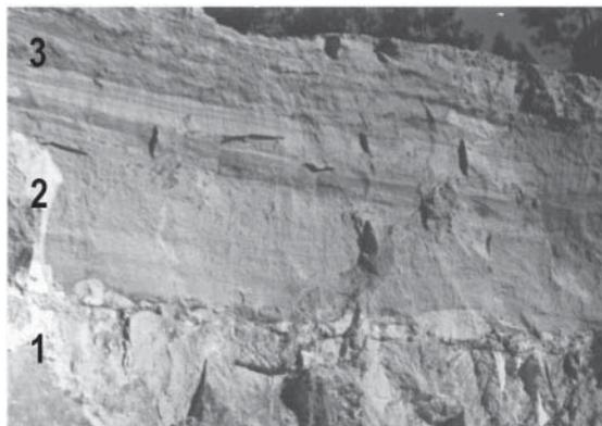
Figura 3 - Aspecto do corte da Rasa. 1- Base com blocos de granito alterado; 2- Camada micácea; 3 - Unidade superior, mais grosseira com estratificação entrecruzada.
