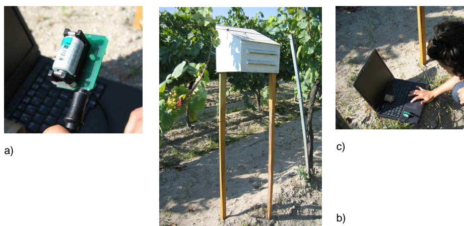
Fotografia 1 – Instrumentos utilizados na aquisição de dados – (a) Sensor de temperatura (b) Abrigo meteorológico (c) Descarregamento dos dados de um sensor de temperatura
