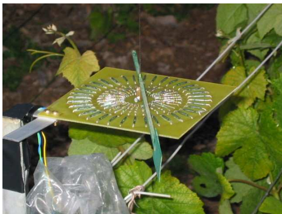
Catavento electrónico sensible a movimientos de ar muito fracos construído por Hervé Quenol par
